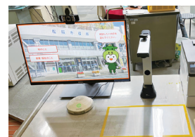
地域振興局に設置された「CROSS」端末。タッチパネルとカメラ、マイクスピーカー、手元の書類を写す書画カメラ、プリンターで構成される。
